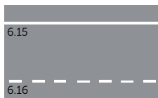
6.15 Linea di margine 6.16 Linea di guida
