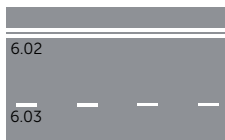
6.02 Doppia linea di sicurezza 6.03 Linea di direzione
