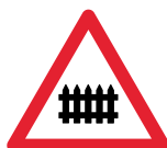
1.15 Barrières (Peut aussi annon- cer l'enceinte d'un aérodrome)
