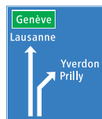
4.38 Vorwegweiser mit Fahrstreifenaufteilung auf Hauptstrassen
