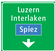
4.69 Einspurtafel über Fahrstreifen auf Autobahnen und Autostrassen
