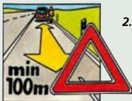
2. **Mettez le triangle de panne en place** (à 100 m au moins en arrière du véhicule). Marchez en vous protégeant au maximum du trafic. Attention : pour raison de sécurité, il n'est pas recommandé d'utiliser le triangle de panne dans les tunnels.
