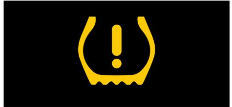
Beispiel-Anzeige eines indirekt oder direkt messenden Systems
