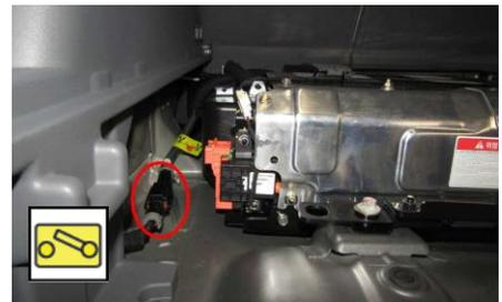
4. Service Disconnect Stecker wie dargestellt entfernen (isolierende Schutzhandschuhe bis 1000 V erforderlich).
