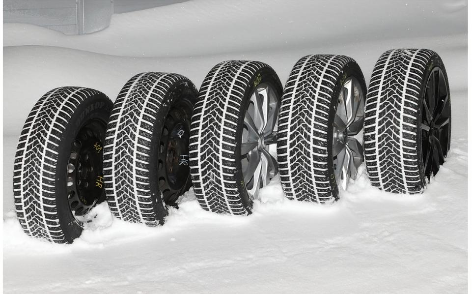
Le pneu le plus grand, soit le modèle de 18 pouces, a battu son concurrent plus petit dans les essais sur route sèche. Sa plus grande surface d'appui et ses flancs plus rigides accroissent la stabilité routière et améliorent les sensations au volant.
