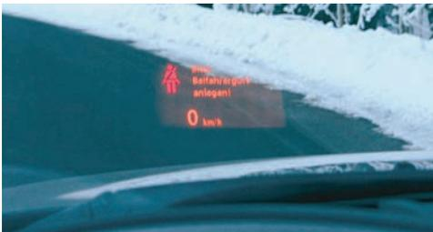
Die Fahrbahn überblicken und gleichzeitig über die Fahrzeuggeschwindigkeit informiert sein: das Head-up-Display macht's möglich.
