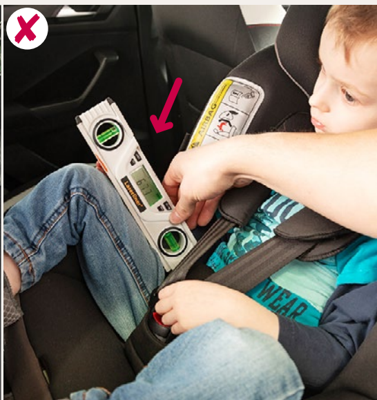
L'enfant est trop grand pour le siège. Les cuisses forment un angle supérieur à 67° au lieu de 45°.
