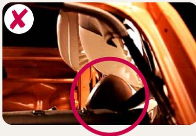
Les rehausseurs dotés de dossiers et de coussins latéraux protègent également l'enfant des chocs contre les structures dures du véhicule en cas de collision latérale :
