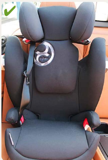
Le rehausseur avec dossier assure un positionnement optimal de la ceinture par-dessus les épaules (réglage de la hauteur) et le bassin (creux). Les coussins latéraux offrent une protection en cas de collision latérale.
