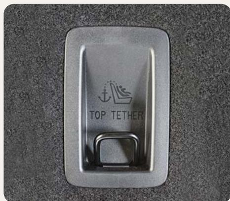
Illustration d'un point d'ancrage Top Tether dans le véhicule. Si vous ne trouvez pas de telle illustration, consultez la notice technique du véhicule pour savoir si ce dernier en est équipé. N'utilisez en aucun cas un quelconque œillet de fixation du coffre !
