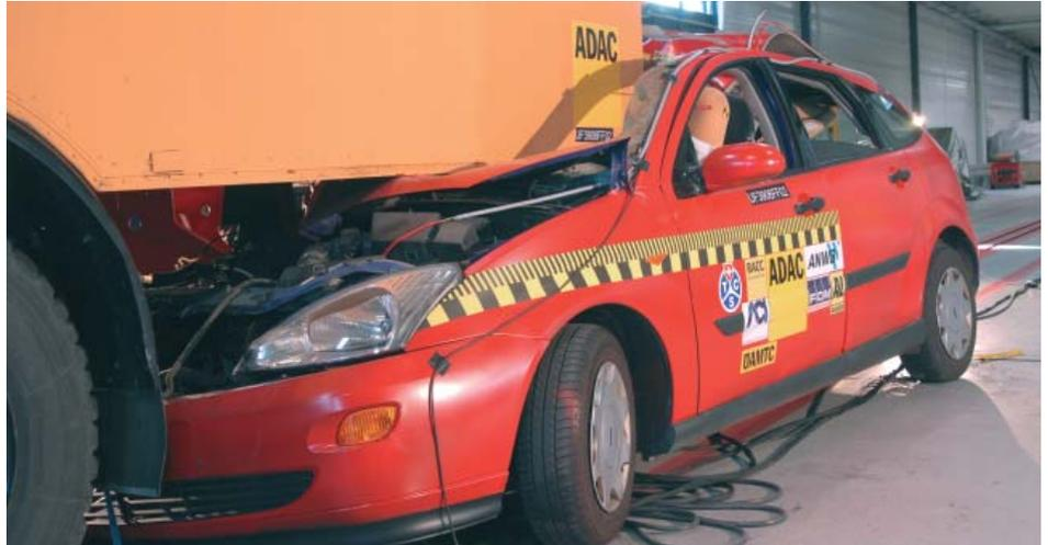
La protezione sottoscocca si rompe, la vettura finisce sotto il camion.
