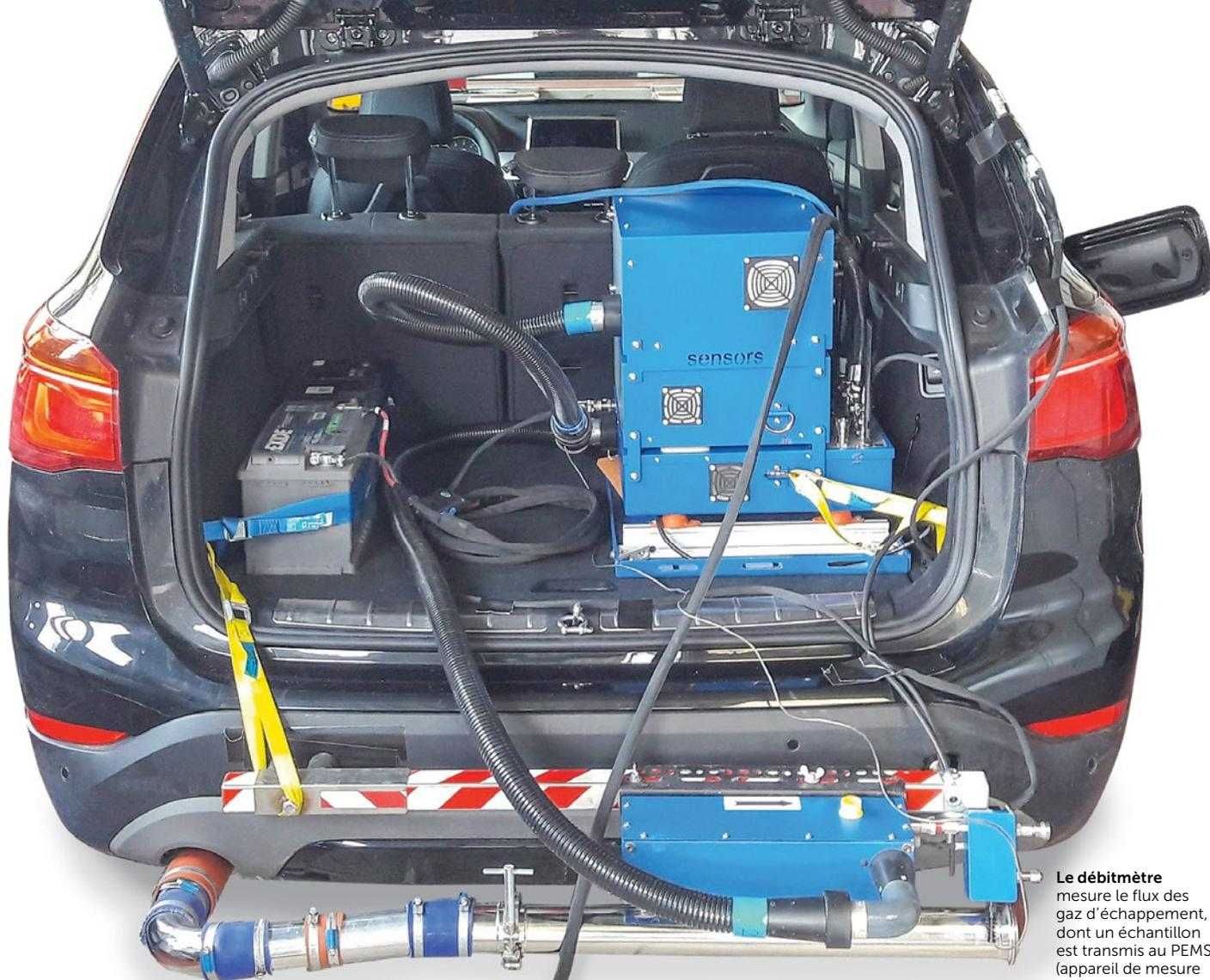
**Le débitmètre** mesure le flux des gaz d'échappement, dont un échantillon est transmis au PEMS (appareil de mesure embarqué).
