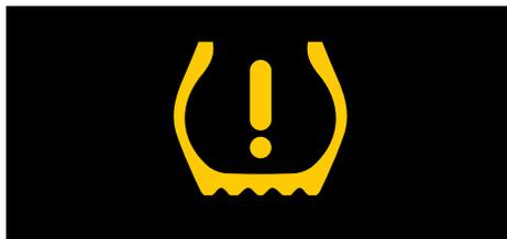
Beispiel-Anzeige eines indirekt oder direkt messenden Systems
