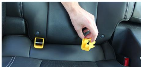
Ces guides en plastique livrés en général avec le siège Isofix sont bien utiles lors de l'installation pour encliqueter correctement le siège.
