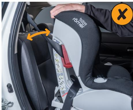
INCORRECT : installation du siège trop lâche – le siège pour enfants vacille et ne peut pas assurer une protection optimale en cas d'accident.
