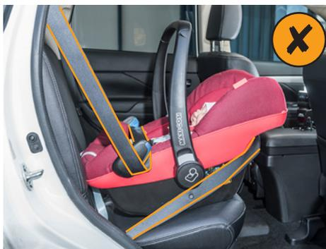
**INCORRECT** : mauvais positionnement de la ceinture. Les sangles peuvent facilement glisser en cas de collision.
