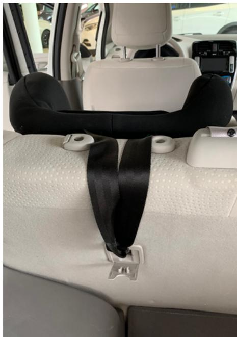
Les sièges pour enfants Isofix avec Top Tether ne peuvent être installés que dans des véhicules disposant des points de fixation requis. Les nouvelles voitures ne doivent être équipées de points d'ancrage Top Tether que depuis novembre 2014. Assurez-vous que les ceintures sont aussi droites que possible.
