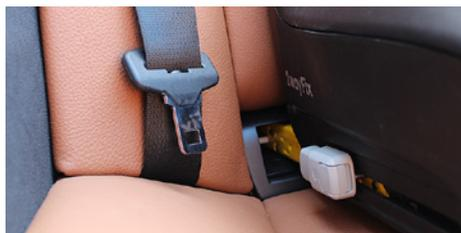
La ceinture du véhicule n'est pas nécessaire pour installer le siège.
