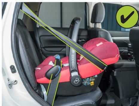
**CORRECT** : positionnement correct de la ceinture. Le siège auto pour bébé est retenu par les ceintures en cas d'accident.
