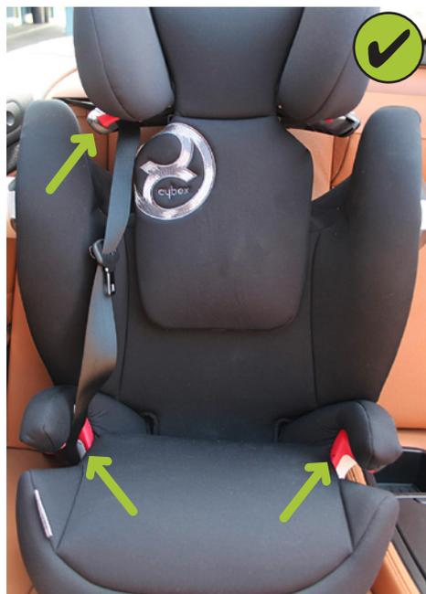
**OPTIMAL** : un rehausseur avec dossier assure un cheminement optimal de la ceinture par-dessus les épaules (réglage de la hauteur) et sur le bassin (creux). Les coussinets latéraux protégeront en cas de choc latéral.
