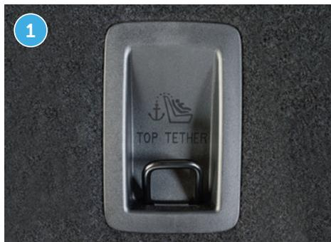
Illustration d'un point d'ancrage Top Tether dans le véhicule. Si vous ne trouvez pas de telle illustration, consultez la notice technique du véhicule pour savoir si ce dernier en est équipé. N'utilisez en aucun cas un quelconque œillet de fixation du coffre !
