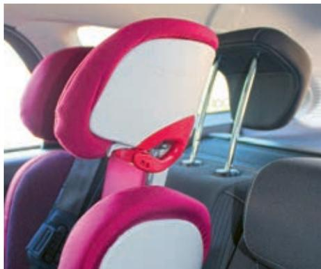
Si nécessaire, montez l'appui-tête à l'envers afin que celui-ci reste à sa place dans la voiture et que le siège enfant puisse être bien ajusté.
