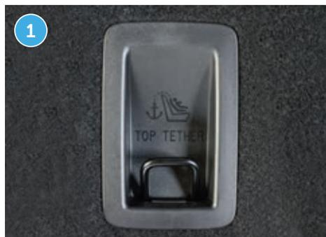
Illustration d'un point d'ancrage Top Tether. Si vous n'en trouvez pas, consultez le mode d'emploi du véhicule pour savoir si ce dernier en est équipé.
