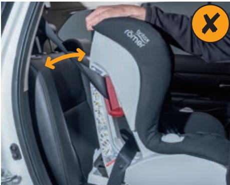
FAUX : installation trop lâche - le siège bouge et ne protège pas de façon optimale en cas d'accident.
