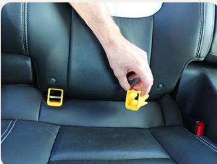
Gli utensili di montaggio in plastica, spesso in dotazione con il seggiolino, facilitano l'accesso ai bracci Isofix.
