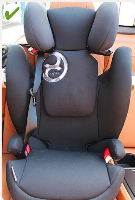
Un rialzo con schienale assicura una posizione corretta della cintura sulla spalla (in altezza) e sui fianchi (bracciacoli). In caso di impatto contro la fiancata, il bambino è protetto grazie all'imbottitura laterale.
