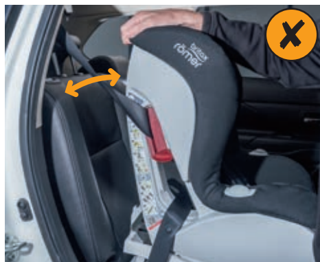
Montaggio instabile; il seggiolino traballante non offre una protezione ottimale in caso di incidente.
