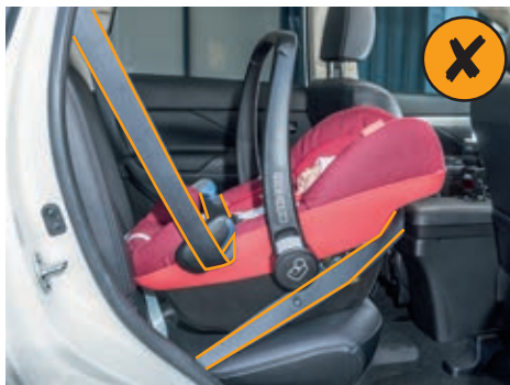
Posizione errata della cintura dell'auto. V'è il rischio che si stacchi in caso di impatto.
