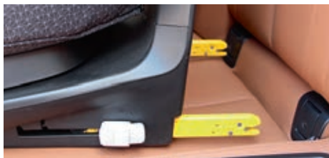
Meccanismo ad incastro: connettere i bracci del seggiolino Isofix agli attacchi nell'incavo del sedile.
