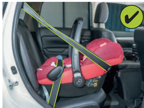
Qui la cintura dell'auto scorre correttamente e ritiene il guscio in caso di impatto.
