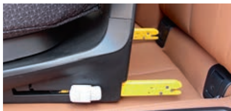
Isofix-Rasterarme in die Ösen führen und andrücken, bis die Klickfunktion greift.
