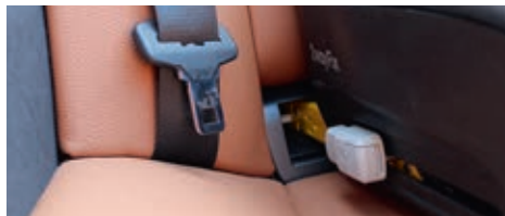
Der Fahrzeuggurt wird zur Fixierung nicht benötigt.
