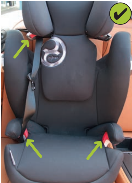
OPTIMAL: Sitz erhöhter mit Rückenlehne garantiert optimale Gurtführung über Schultern (Höhenversteller) und Becken (Hörnchen). Die seitlichen Polster bieten Schutz bei einer Seitenkollision.
