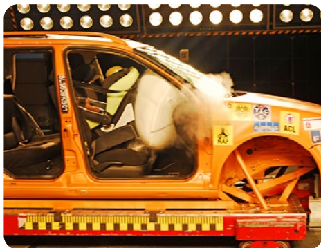
Pericolo mortale: quando l'airbag si apre a una velocità di circa 250 km/h, il bambino resta schiacciato contro lo schienale.
