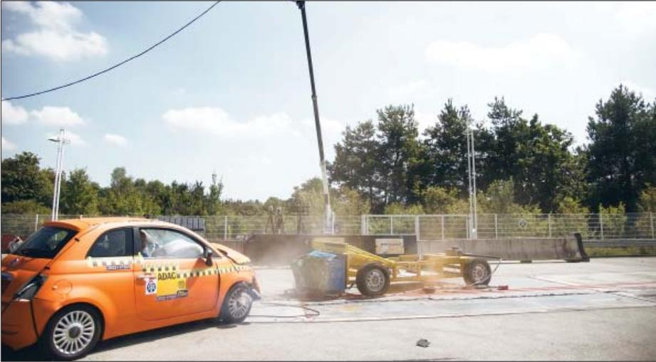
**2008 führte der TCS einen Crashtest mit zwei Fahrzeugen von unterschiedlicher Masse, Struktur und Geometrie durch. Dieser Vorgängertest zeigte ein erhöhtes Verletzungsrisiko für die Insassen – insbesondere des schwächeren Fahrzeugs – bei einem Frontalcrash. Ein neues Testverfahren ermöglicht nun fahrzeugübergreifende Vergleiche. Werden diese Erkenntnisse konsequent umgesetzt, könnte das Verletzungsrisiko auf den Schweizer Strassen deutlich verringert werden.**
