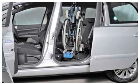
Porte coulissante avec ascenseur pour fauteuil roulant.
