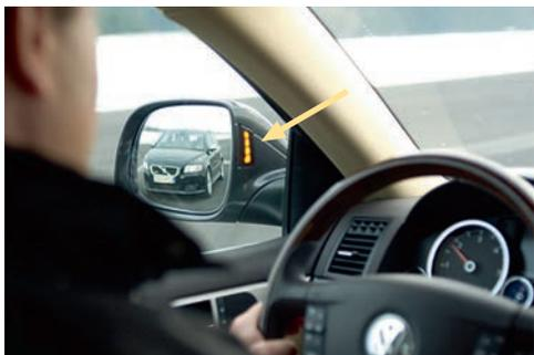
L'assistente angolo cieco migliora la visibilità, facilitando i cambi di corsia.
