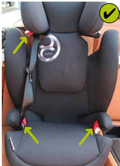
**OTTIMALE:** un rialzo con schienale assicura una regolazione ottimale della cintura sulla spalla (in altezza) e sui fianchi (braccioli), meglio se imbottiti. In caso di impatto laterale il bambino è quindi protetto meglio.
