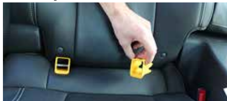
Kunststoffmontagehilfen ermöglichen einen einfacheren Zugang zu den Isofix-Rasterarmen. Sie werden häufig mit den Isofix-Kindersitzen mitgeliefert.
