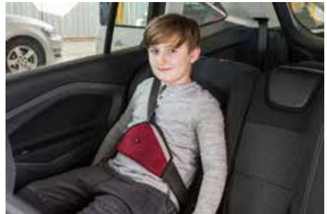
Gurtadapter erhöhen die Verletzungsgefahr im Bauchbereich. Ohne ECE-Genehmigung sind Gurtadapter in der Schweiz nicht zugelassen.
