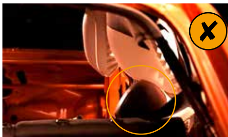
GEFÄHRLICH: Auch Seitenairbags können bei einer Seitenkollision nicht verhindern, dass das Kind mit dem Kopf gegen harte Fahrzeugstrukturen prallt.
