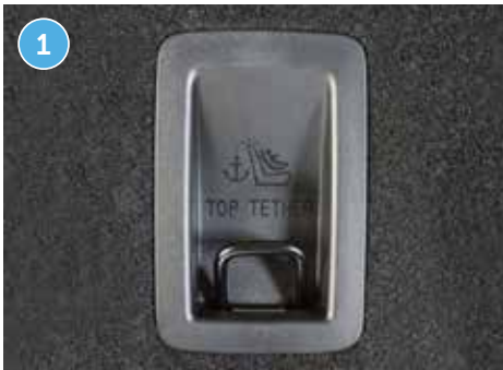
Abbildung eines Top-Tether-Verankerungspunkts im Auto. Falls er nicht entsprechend gekennzeichnet ist, steht in der Betriebsanleitung des Fahrzeugs, ob es sich um eine Top-Tether-Verankerung handelt. Auf keinen Fall irgendeine Verzuröse im Kofferraum verwenden!
