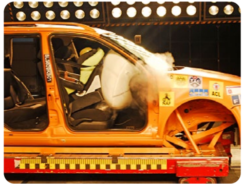
Tödliche Gefahr: Das Kind wird gegen die Sitzlehne geschleudert, wenn sich der Beifahrerairbag mit rund 250 km/h entfaltet.
