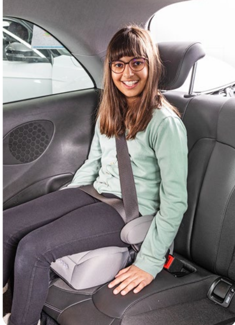
Sitzerhöher ohne Rückenlehne: Sitzerhöhung und Hörnchen stellen sicher, dass der für Erwachsene dimensionierte Sicherheitsgurt richtig sitzt.
