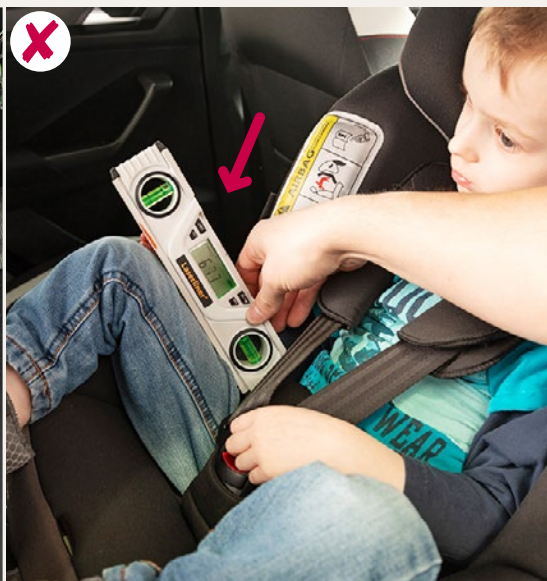
Das Kind ist zu gross für den Sitz. Die Oberschenkel weisen einen Winkel von mehr als 67° anstatt 45° auf.
