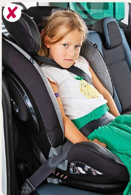
Das Kind ist zu klein für die Sicherung mit dem 3-Punkt-Gurt. Der deutliche Gurtkontakt am Hals kann bei einem Unfall zu schweren Verletzungen führen.
