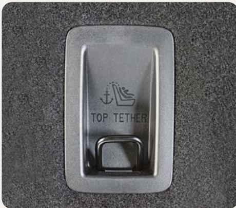
Abbildung eines Top-Tether-Verankerungspunkts im Auto. Falls er nicht entsprechend gekennzeichnet ist, steht in der Betriebsanleitung des Fahrzeugs, ob es sich um eine Top-Tether-Verankerung handelt. Auf keinen Fall irgendeine Verzurröse im Kofferraum verwenden!
