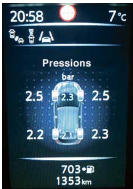
Affichage d'un système TPMS à mesure directe.
