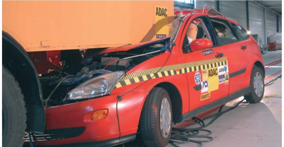
Unterfahrschutz bricht. Auto fährt unter den LKW.
