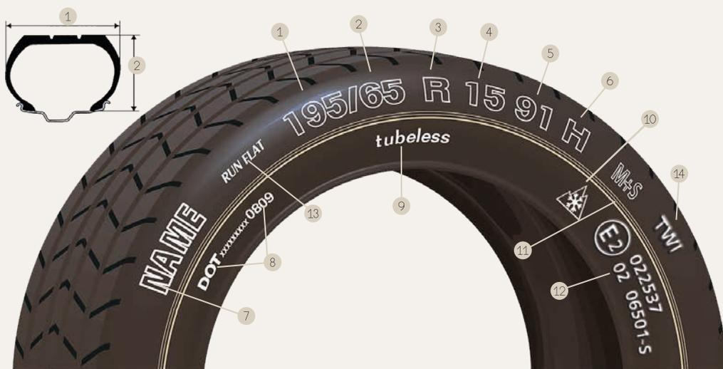
10 Le symbole de flocon de neige avec montagne à 3 pics signifie pneu approprié en hiver. À la différence du pneu M+S, le pneu avec ce symbole a satisfait à des critères de test spécifiques sur la neige. Seul un pneu avec ce symbole de flocon de neige avec montagne à 3 pics est un pur pneu d'hiver.
