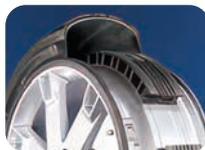
speciale) che, in caso di foratura, supporta la vettura e consente di raggiungere il punto di assistenza più vicino a max. 80 km/h.
