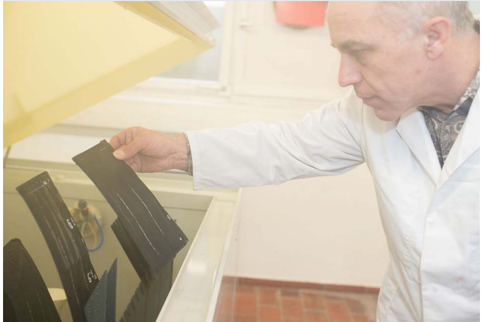
Verschiedene Kotflügelbleche beim Korrosionstest mit Salzsprühnebel.
