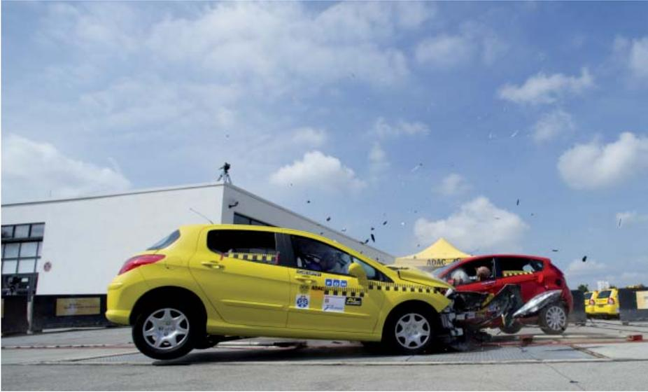
Der TCS überprüfte anhand von zwei ähnlich schweren Fahrzeugen die Sicherheit beim Crashtest gegeneinander und verglich sie mit den bereits durchgeführten Einzeltest. Das Resultat: Die Verletzungen der Insassen würden bei einem realen Unfall höher ausfallen. Dies ist vor allem auf die unterschiedlichen Strukturen der Unfallgegner zurückzuführen.
