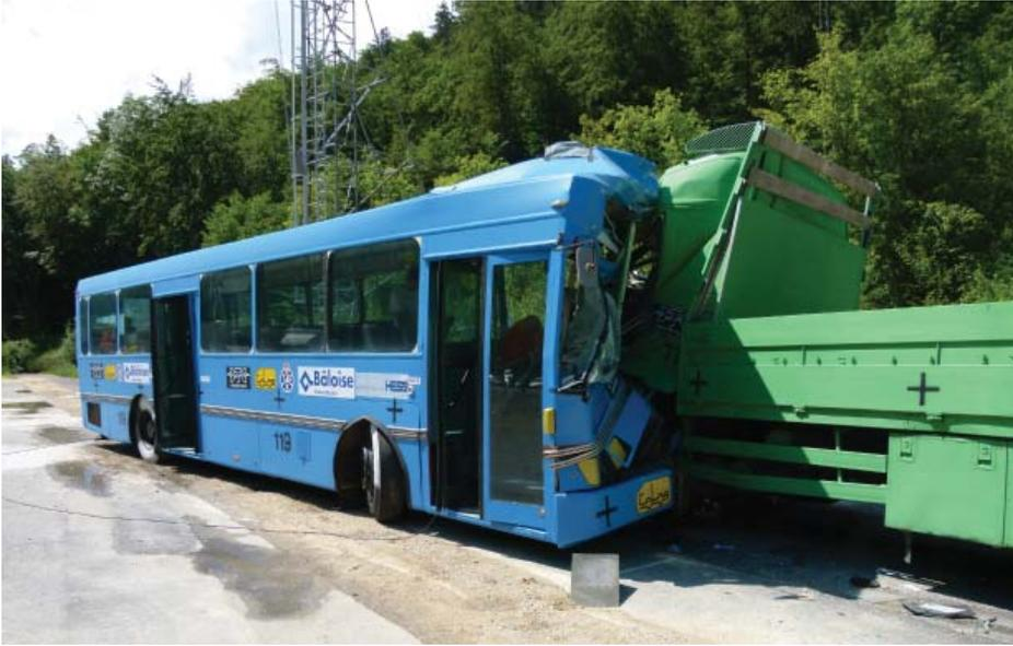
**Un crash-test avec un car réalisé par le TCS, la Bâloise et le Dynamic Test Center (DTC) apporte une preuve incontestable: des passagers sans ceintures de sécurité n'ont que peu de chances de survie en cas de collision. Le TCS recommande donc de toujours s'attacher dans un car pour se protéger soi-même et les autres passagers. Le législateur exige le port de la ceinture de sécurité en car depuis 2006 déjà. Seuls les bus des transports publics de ligne sont exclus de cette obligation.**
