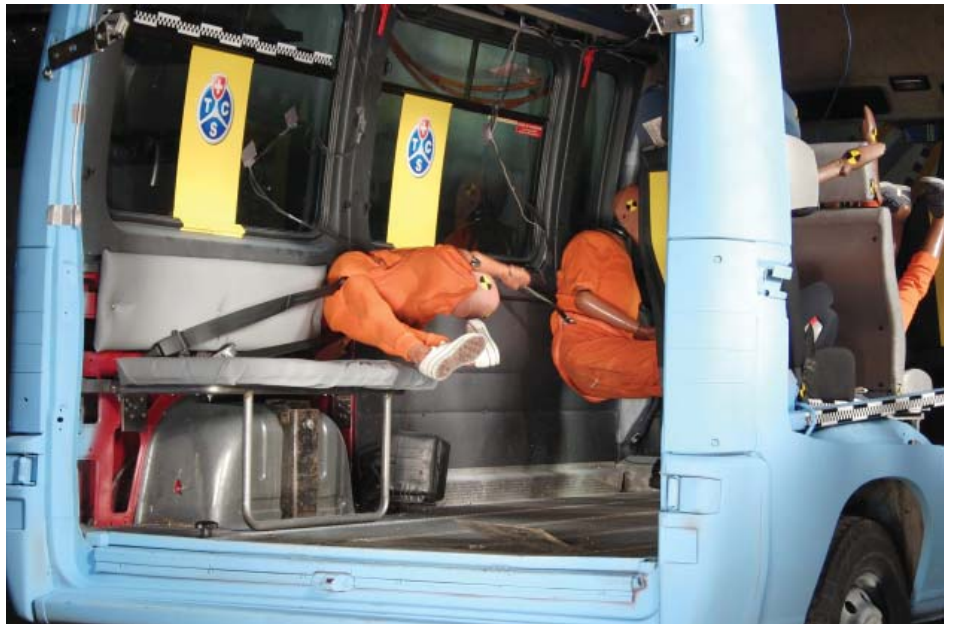
Le mannequin non assuré a été projeté contre le siège du conducteur et la portière. Le mannequin sur la banquette longitudinale assuré par une ceinture ventrale a subi une décélération en raison de l'enrouleur du dispositif défectueux. Dans les deux cas, la sécurité n'était pas assurée!!!
