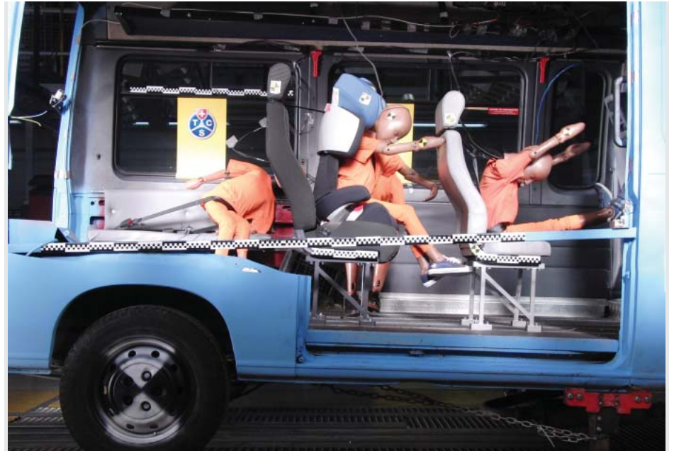
Les deux mannequins transportés face à la route, l'un dans un siège d'enfant, l'autre dans un siège aux dimensions réduites, ont été bien protégés.
