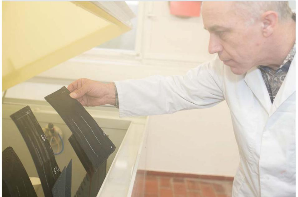
Test anticorrosion avec brouillard salin sur la tôle de différentes ailes de voiture.
