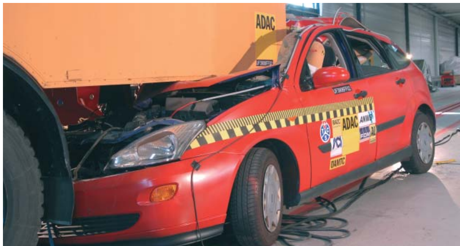
La barre anti-encastrément se brise. La voiture s'encastre sous le poids lourd.
