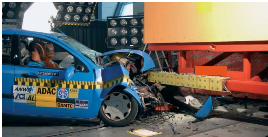
La barre anti-encastrément tient le choc. Les passagers sont protégés.
