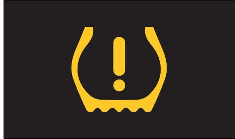
Exemple d'affichage d'un système SSPP à mesure directe ou indirecte.
