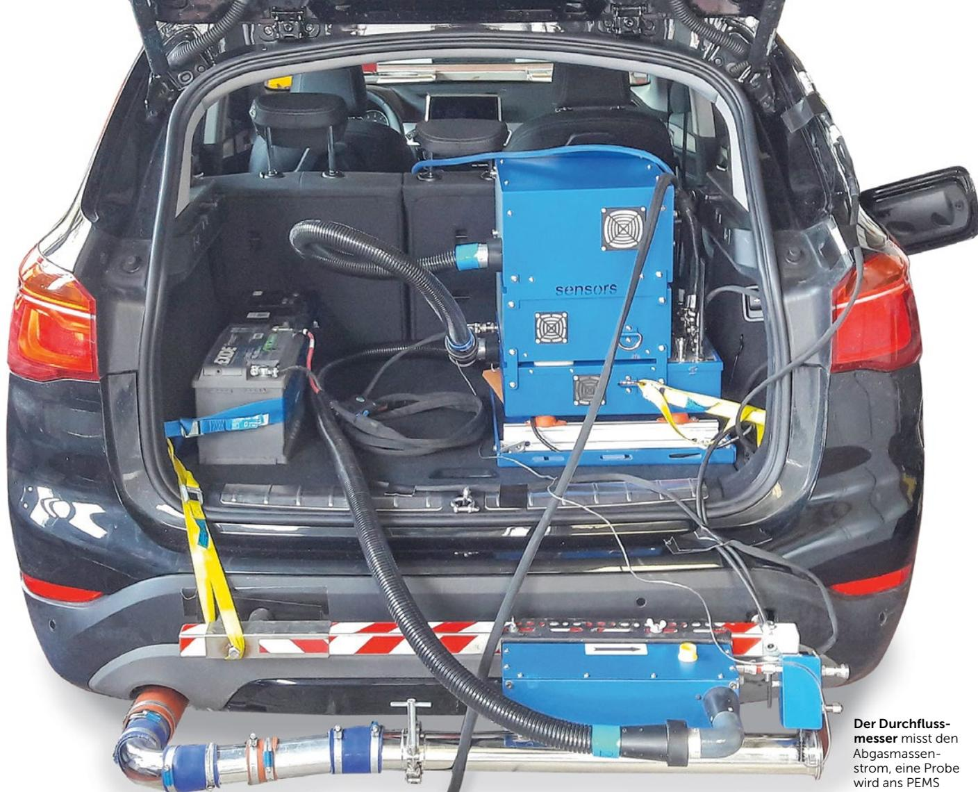
Der Durchflussmesser misst den Abgasmassenstrom, eine Probe wird ans PEMS geleitet
