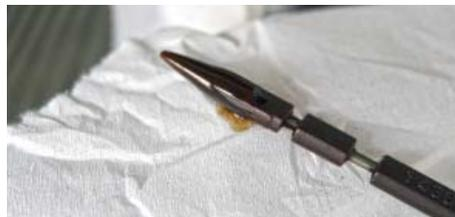
Das Öl-Niveau muss auf dem Messstab zwischen der Minimum- und Maximum-Markierung liegen. Zu viel und zu wenig Öl kann dem Motor schaden.
