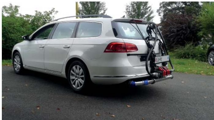
La VW Passat pronta per la verifica delle emissioni con PEMS.
