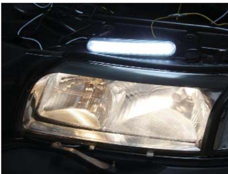
Das Foto zeigt den Unterschied: LED-Tagfahrlicht ist besser sichtbar. Der Gesamtverbrauch beläuft sich auf bis zu 15 Watt (LED-Tagfahrleuchten) im Vergleich zu 200 Watt beim Abblendlicht.
