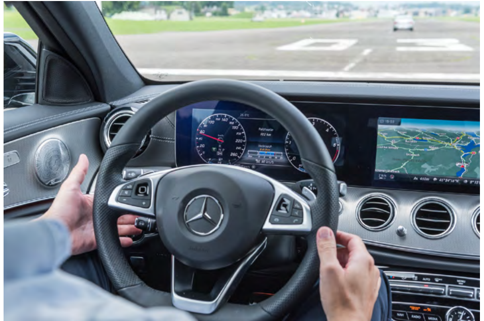
Test assistente mantenimento corsia attivo effettuato all'aeroporto
