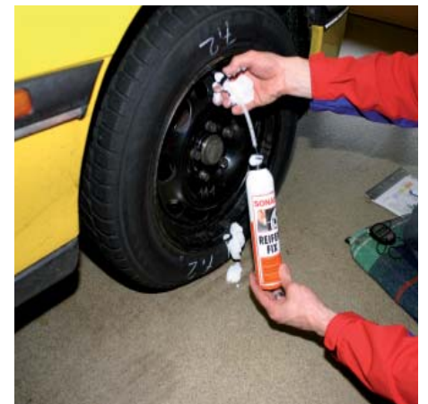
Sehr starkes Austreten von Dichtmittel während des Füllvorganges.
