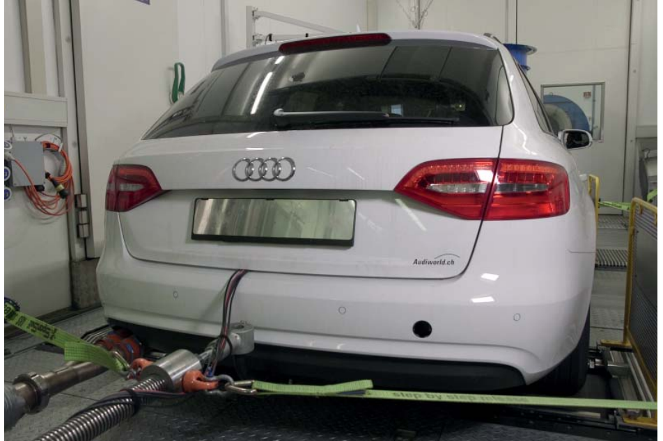
Audi A4 Avant TDI bei Abgasmessung.
