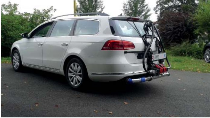
VW Passat, bereit für Emissionsmessungen auf der Strasse mit PEMS.
