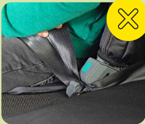
Cinturón mal colocado, el niño no está correctamente protegido.
