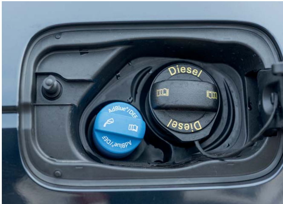
Deux réservoirs: l'orifice de remplissage d'additif voisine celui de carburant.
