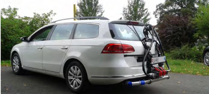
La VW Passat, équipée du PEMS, prête pour les mesures sur route.
