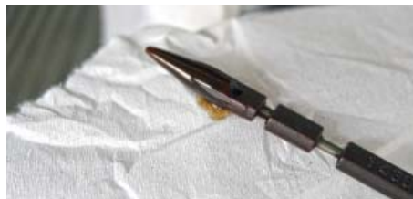
Le niveau de l'huile doit se situer entre le minimum et le maximum. Trop ou pas assez d'huile peut endommager le moteur.
