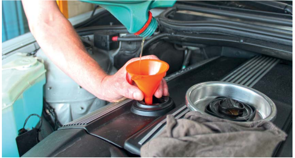
Ne pas trop remplir! Contrôler de temps en temps le niveau avec la jauge et faire attention que le couvercle ne tombe par terre et soit sali.
