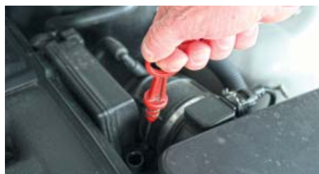
Couper le moteur et attendre quelques minutes avant de contrôler le niveau pour que l'huile puisse s'accumuler dans le carter d'huile.
