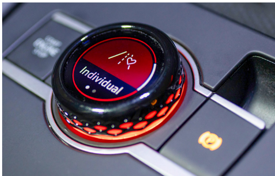
Il selettore «Driver Experience» nella console centrale, per modalità di guida e volume.
