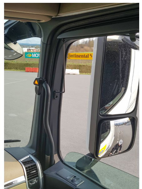
Ein Warnlicht weist auf einen Radfahrer im toten Winkel des Fahrzeuges hin
