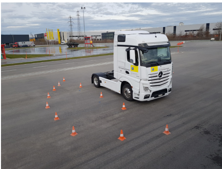
Objekte im markierten Bereich werden erfasst. Ganz nah am Lastwagen bleibt ein unüberwachter Bereich.
