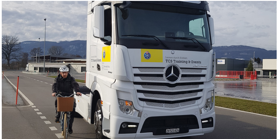
Blinder Fleck Würde der Velofahrer am Fahrerhaus anlehnen, sähe ihn der Abbiegeassistent nicht
